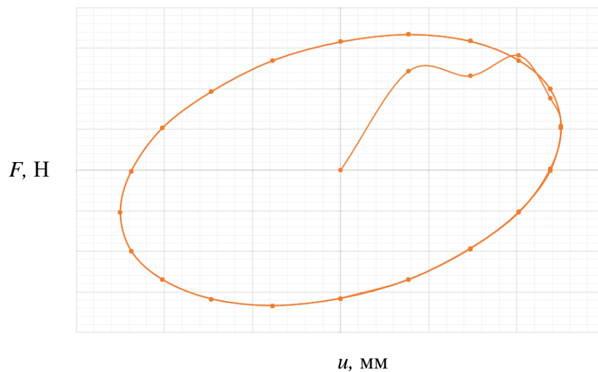
Рисунок 7 – Расчетная зависимость реакции от перемещения при синусоидальной нагрузке
